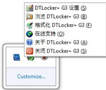
图 5.1 任务栏中的 DTL+ G3 图标
